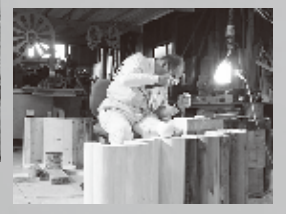
④改修前の状態の良かった部分は残し、新しいヒノキと組み合わせていきます。
