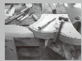
④改修前の状態の良かった部分は残し、新しいヒノキと組み合わせていきます。
